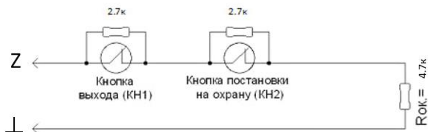
Рис. 4. Схема подключения в шлейф «Кнопки постановки на охрану» и «Кнопки выхода»
