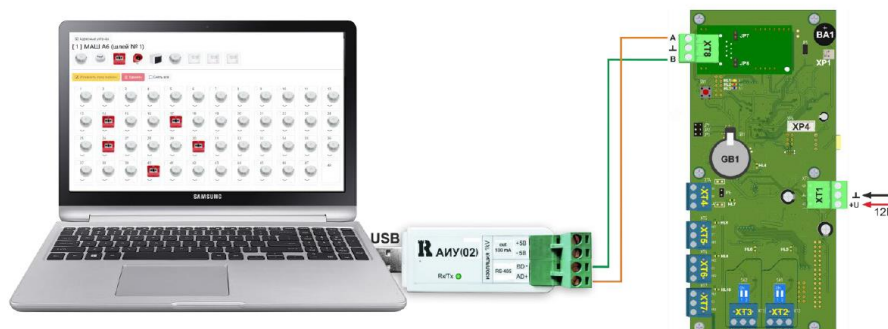
Рис. 6. Схема подключения прибора к ПЭВМ
