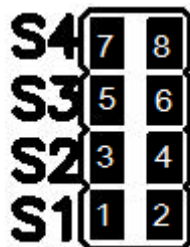
Рисунок 3.1.2 – Перемычки режимов работы контроллера турникета
