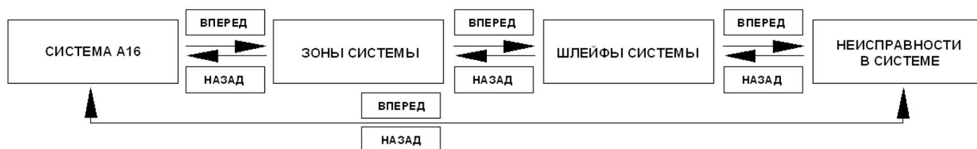
Рис. 6. Структурная блок-схема работы ВПУ-А-16 в режиме «Обзор»
