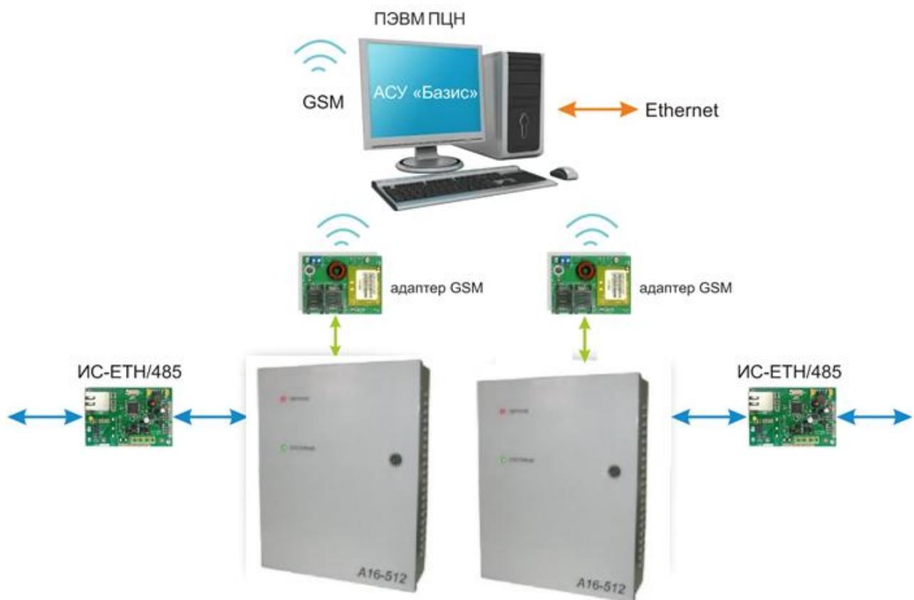
Рис. 16. Структурная схема объединения приборов в сеть в СПИ АСУ «Базис» по каналам связи GSM или Ethernet
