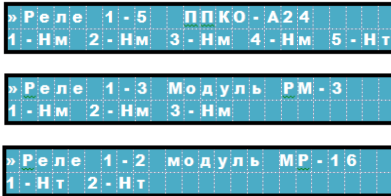
Рис. 30. Вид текущего состояния реле прибора и компонентов
