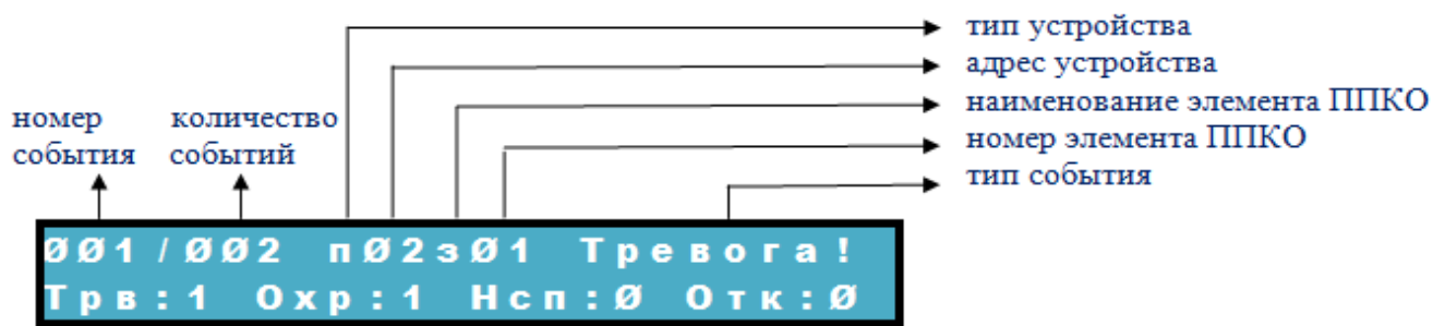
Рис. 11. Индикация дисплея при поступлении новых событий
