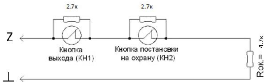
Рис. 3. Схема подключения в шлейф «Кнопки постановки на охрану» и «Кнопки выхода»
