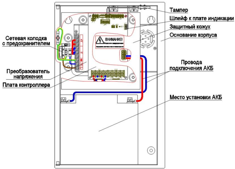
Рис. 1 Внешний вид и расположение конструктивных элементов БП (при снятом защитном кожухе)
