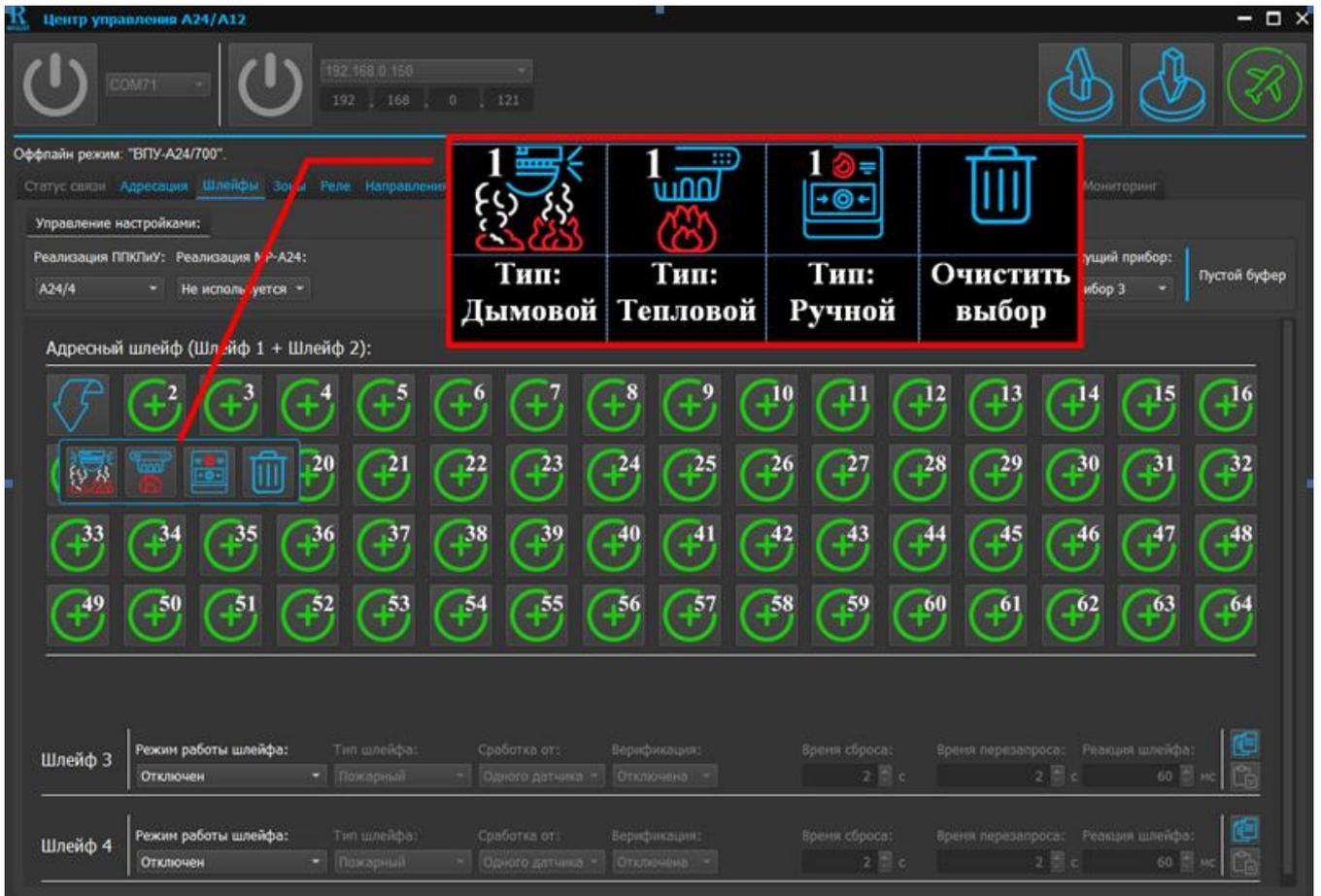
Рисунок 39. Закладка «Шлейфы». Выбор типа адресного датчика
