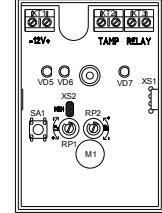
Рис. 2. Расположение и обозначение элементов на плате извещателя
