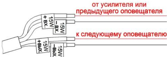
Рис. 2. Схема подключения оповещателя
